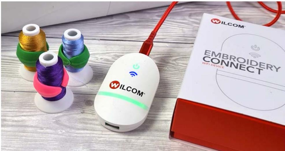
Die meisten Stickmaschinen können Dateien von einem Standard-USB-Memorystick lesen. Mit EmbroideryConnect entfällt die Notwendigkeit von seriellen Schnittstellen, unterschiedlichen Schnittstellenmethoden oder Kabeln an der Maschine.
